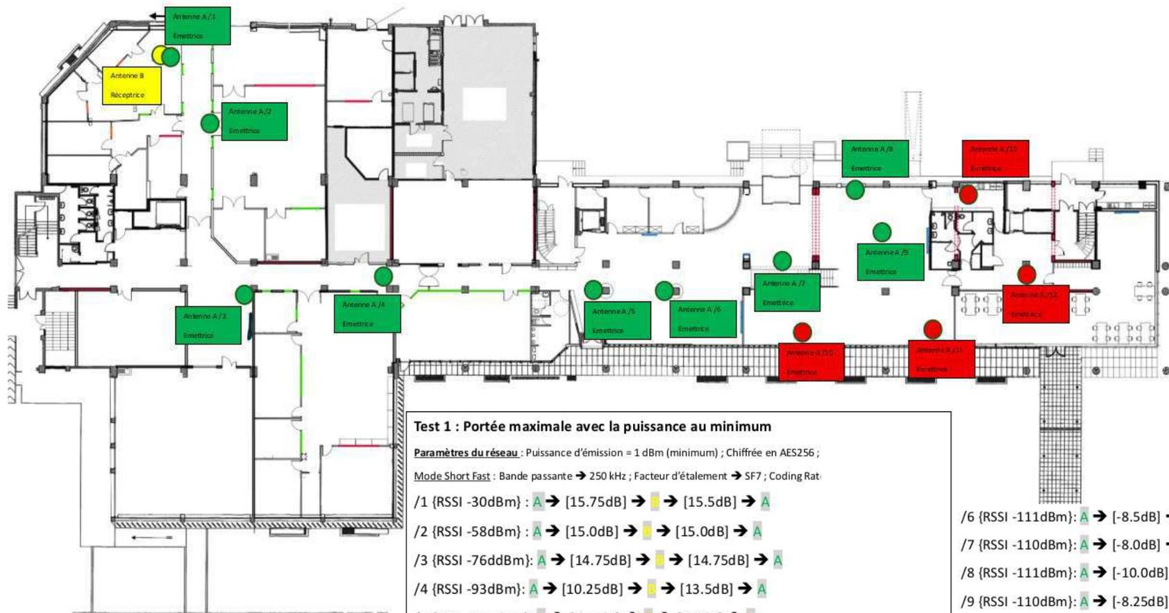
**Test 1 : Portée maximale avec la puissance au minimum**
