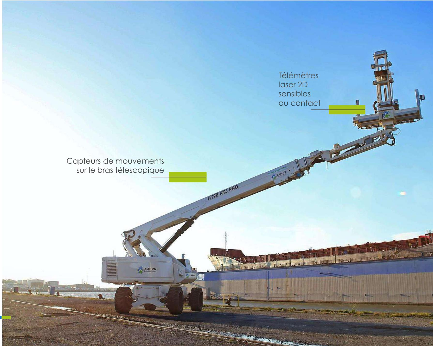
Télémètres laser 2D sensibles au contact
