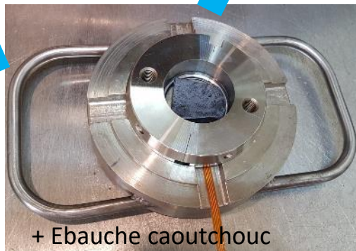
Circuit positionné sur armature dans un moule
