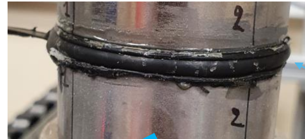
Compression sous 20 kN (@1,5mm)
