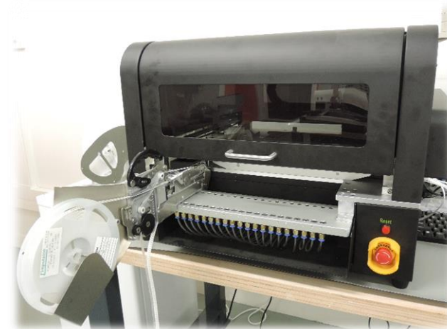
Machine de placement de composants électronique automatique
